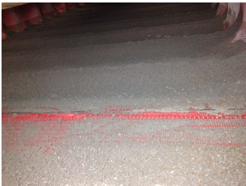
Figur 15 Dårlig sigtefunktion (blinding)
