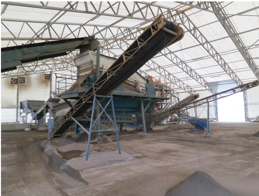
Figur 2 Sigte, af typen flip-flow leveret af Binder + Co (Østrig). Sigten er forsynet med 2 sigtesold over hinanden, dvs. den kan producere 3 størrelsesfraktioner i samme arbejdsgang..
