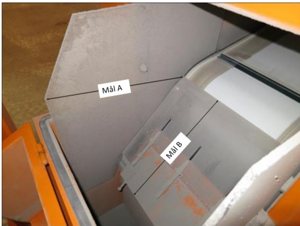
Figur 29 Splitter position. Målene A og B er anvendt til målsætning af splitteren i forsøgene.
