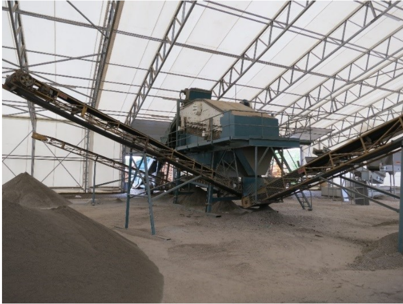
Figur 12 Sigten med bånd der er benyttet til at udføre sigteforsøg. Sigten er en Bivitec [producent Binder+co, Gleisdorf Østrig, KrL/DD-1s 1900X5, 2012].
