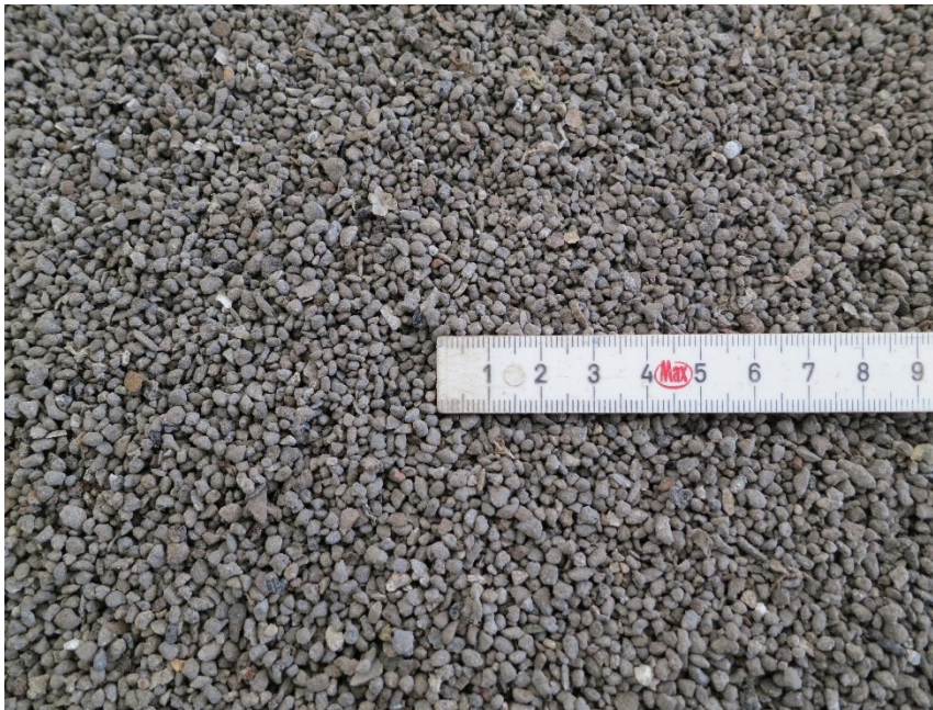
Figur 24 Foto af fraktionen 2-4 mm efter sigtning (eksempel). Materialet ses at være løst bundet.
