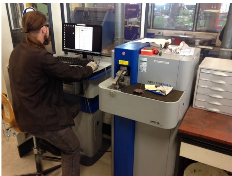
Figur 53 Analyse af prøveemne i Optical Emission Spectrometer.
